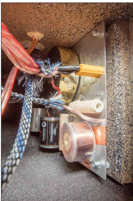
Die Frequenzweiche sitzt in einem eigenen Abteil im Tieftönergehäuse
