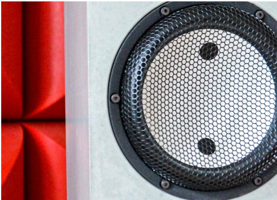
*Der bekannte 17 cm Konusmitteltöner mit extrem steifer Keramikmembran von Accuton mit den charakteristischen schwarzen Dämpfungspunkten. In der Arrivato läuft er von 200 Hz bis 2.200 Hz (Foto: H. Biermann)*
