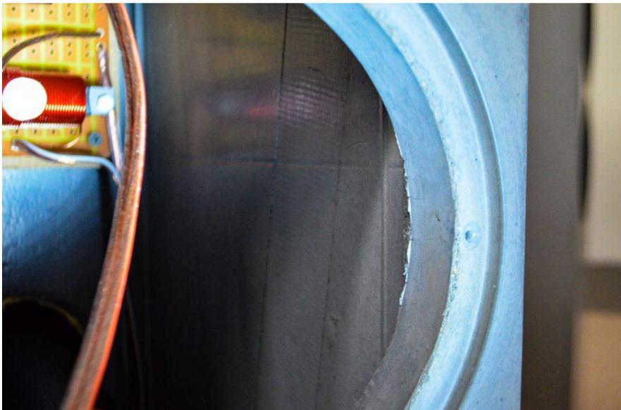
Die Schallwand der Betonart Arrivato ist 2,5 Zentimeter stark und dank der wiederverwertbaren Form so perfekt, dass auch die Treiber auf den Millimeter genau eingelassen sind (Foto: H. Biermann)
