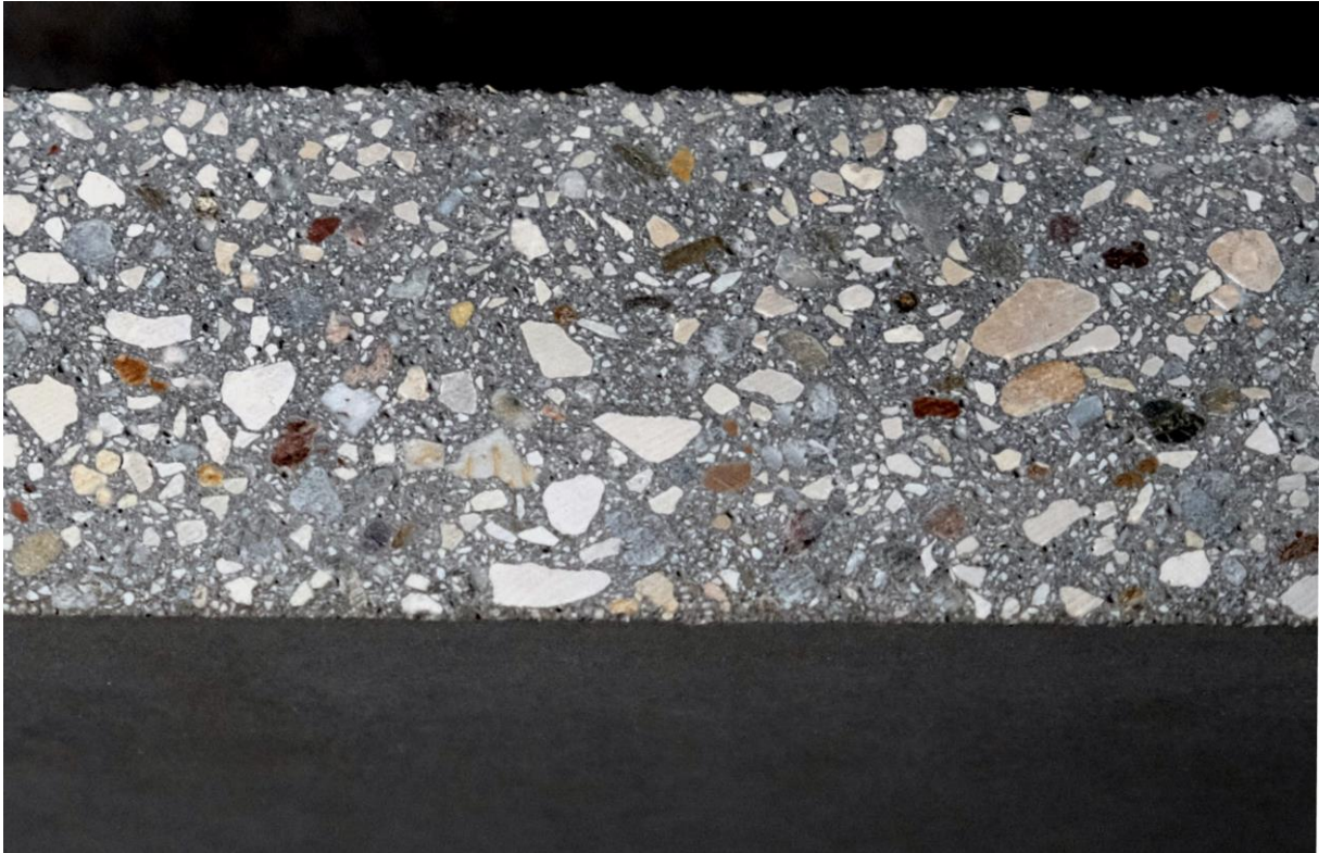
Auf der Unterseite sind die Wände offenporig. Hier sieht man gut die amorphe Zusammensetzung des Betonart-Betons (Foto: H. Biermann)
